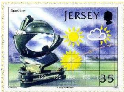
L'appareil est réalisé pour enregistrer les heures d'ensoleillement qui brûle un trou à travers la carte. La sphère de verre - généralement de 10 cm (4 pouces) de diamètre - est conçue pour concentrer les rayons du soleil sur une carte montée à l'arrière et est fixée sur un support. La carte
