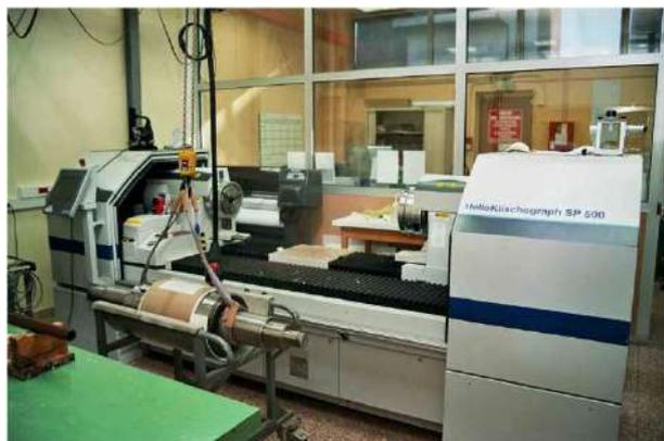
Nous repartons du poinçon non cémenté, qui est encre et photographié. La photo est numérisée en un fichier. Un tour numérique recopie cette image numérisée autant de fois que l'exige le "plan d'imposition prédéfini" par enfoncement du cylindre recouvert de cuivre, à l'aide d'une tête de diamant.
