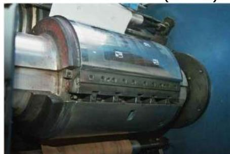
Elle est pulvérisée de sel d'argent et trempée dans un bain galvanoplastique qui dépose une couche de cuivre de 0,8 à 1,0 mm.
