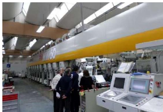
Presse rotative Hélio 10 couleurs HEL-307 avec le bloc n°10 réservé à l'impression des barres phosphorescentes.
